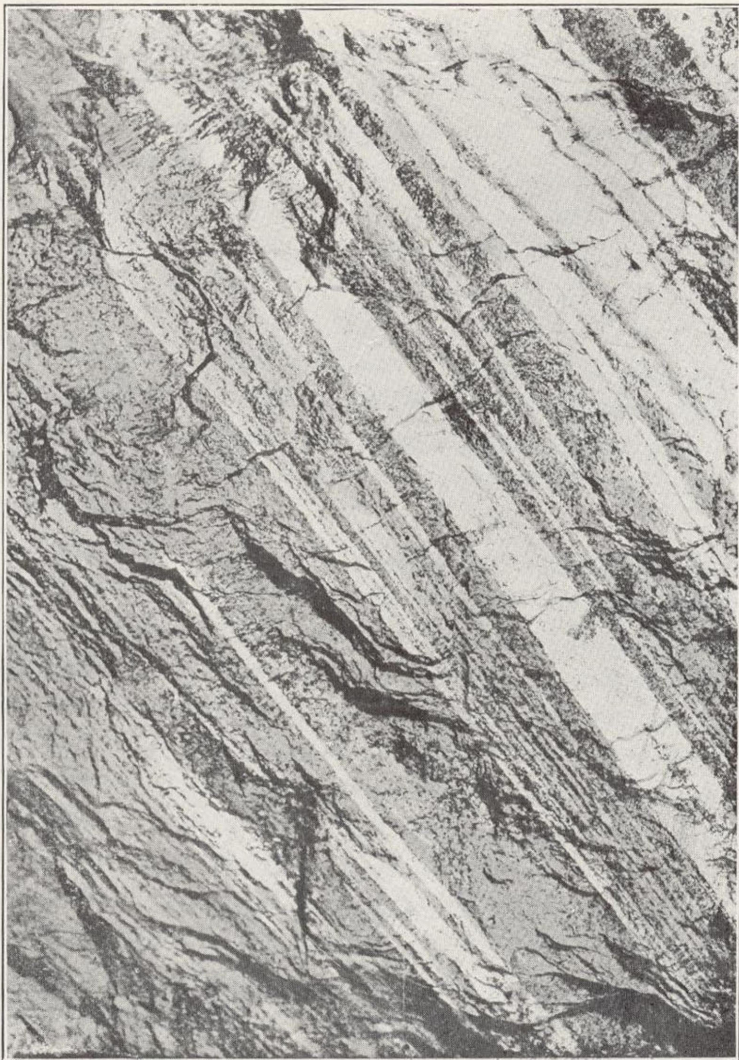
Interior de la mina de Suria de la Sociedad Solvay y Cia. Vetas alternantes de silvinita y sal común.
